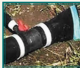
4. На тройниках и переходнике есть пластмассовые кольца, которые используются в качестве хомутов. Надеваете шланг на тройник и сверху на шланг натягиваете пластмассовое кольцо, которое фиксирует шланг на тройнике.
