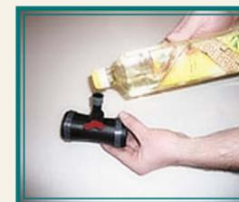
5. Внимание, кран на тройнике запрессован. Во избежание поломки лепестков ручки крана нужно: залить несколько капель подсолнечного или любого другого технического масла в отвод тройника.
